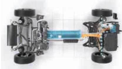
La batterie, compacte, est fixée au centre de la voiture pour créer une distribution du poids équilibrée avec un centre de gravité bas. Profitez d'une maniabilité très sûre et d'un généreux espace pour les passagers et les chargements.
